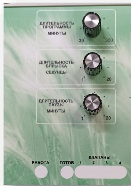
Используя регуляторы на блоке управления установите длительность временного интервала («пауза») между открытием клапанов по очереди. Время паузы в минутах. Если это время установлено на 5 минут, то после подачи воды с первой трубы, через 5 минут начнётся подача со второй и т.д. Продолжительность открытого состояния клапана устанавливается от 1 до 10 сек. (Время разбрызгивания - «впрыск»).
