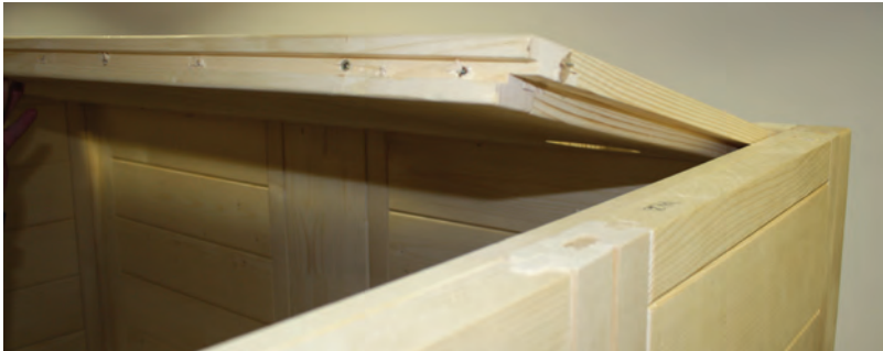
Abb. 18: Einlegen der Dachelemente 1
