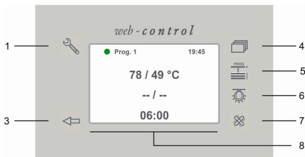
Рис. 16: Окно управления устройством WEB-CONTROL
