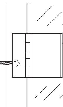
W celu wyregulowania pozycji skrzydła drzwi w pionie lub poziomie należy poluzować śrubę mocującą zawias do szyby. W celu regulacji głębokości drzwi należy poluzować zawias (zawiasy) wymagający regulacji i wsunąć przekładkę odstępową (patrz rys.) pomiędzy zawias a futryną.
